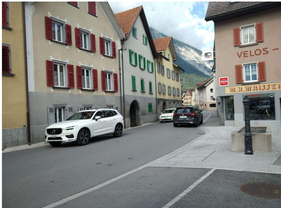
Abbildung 23: Referenzbild Domat/Ems. Überfahrbare Randsteine, Einsatz von Pflasterungen auf kurzen Strecken, Verzahnung der Vorzonen mit dem Strassenraum
