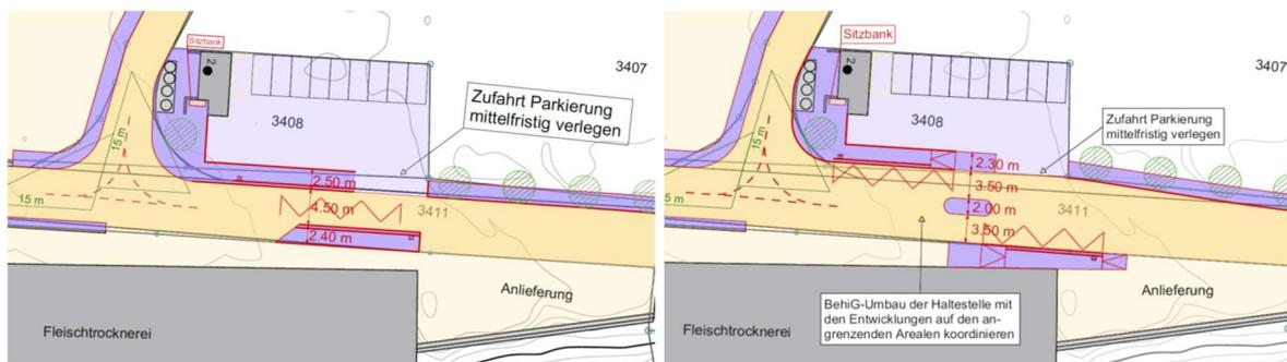
Abbildung 15: Bushaltestelle Quadris. Die links abgebildete Untervariante mit einer Kaphaltestelle wurde aus verschiedenen Gründen nicht weiterverfolgt (Gewerbe- und Forstverkehr, Schleppkurven). Die rechts abgebildete Fahrbahnhaltestelle ist nur in der dargestellten Form nur unter Einbezug privater Grundeigentümer möglich, weitere Abklärungen und eine Abstimmung auf die Entwicklung der umliegenden Areale ist erforderlich.
