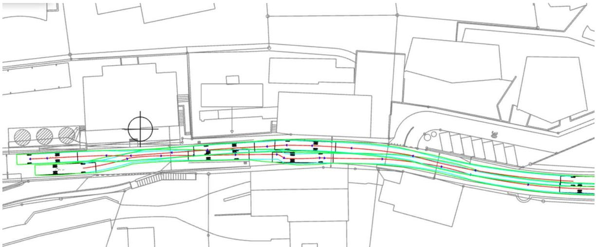
Abbildung 17: Begegnungsfall Bus / Bus (15m) im Bereich der Parz. Nr. 3243. Dieser Begegnungsfall ist nur knapp möglich. Es ist anzustreben, dass der vom Dorfplatz kommende LKW vor der Einmündung Portalavanda die Abfahrt des Postautos abwartet (Sichtbeziehung möglich). Die Einengung bei Parz. Nr. 3622 macht darauf aufmerksam.
